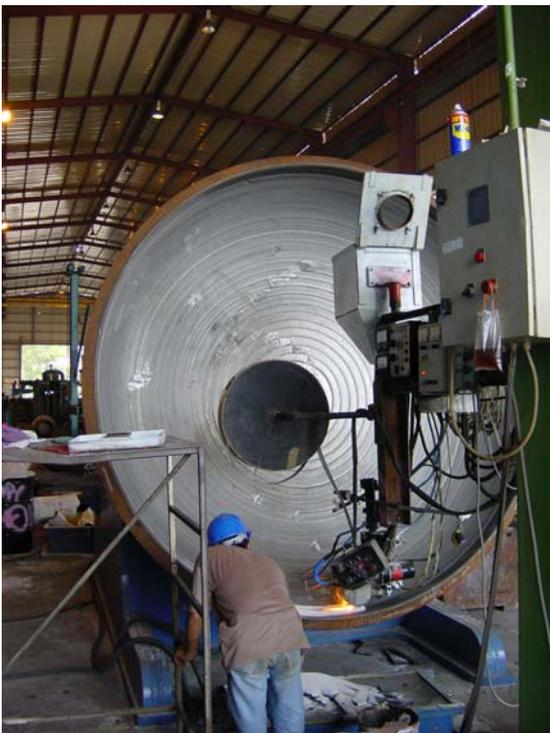
**Bild 8:** RES-Schweißplattieren mit Sinterbandelektrode DINEL 625 S
