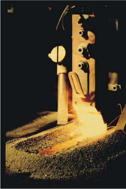
**Bild 1:** RES-Auftragschweißprozeß
