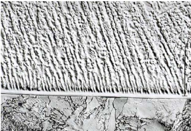
**Bild 4:** Mikrostruktur in der Übergangszone Grundwerkstoff / Plattierung
